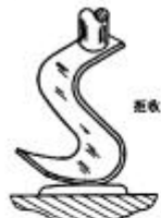
图 2074-7 触须钩形接触
