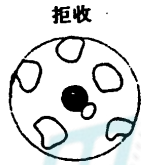
图 2071-1 超过引出端至外壳距离一半的径向裂纹
