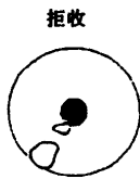
图 2071-3 超过玻璃密封区 1/3 的气泡
